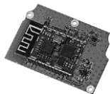
Módulo Bluetooth incorporado (en la radio)
